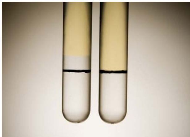
Образец проб топлива для проверки на присутствие этилового спирта по методу, рекомендованному некоторыми разрешительными органами, в частности, Управлением гражданской авиации Великобритании (см. пункт 4b брошюры UK CAA Safety Sense Leaflet)
